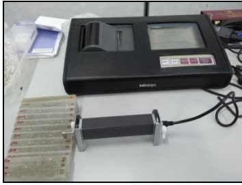
Rajah 6: Penguji Kekasaran Permukaan Mudah Alih SurfTest ST-301
