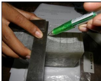
Rajah 2: Mengukur bahan kerja
