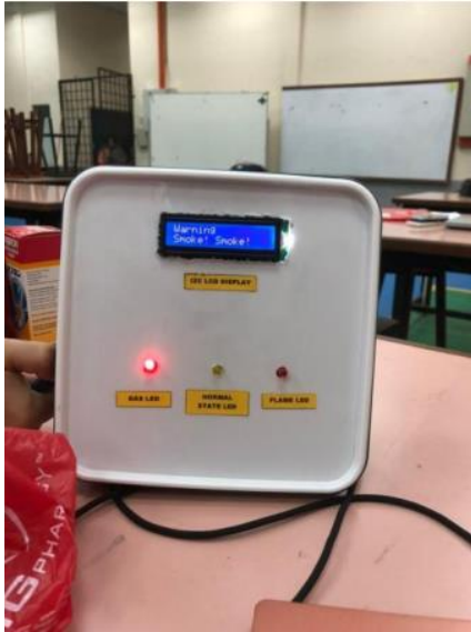
Rajah 5: Mengesan kehadiran haba atau api
