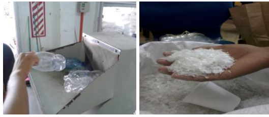
Rajah 3: (a) Proses meracik botol (b) Botol telah siap diracik
