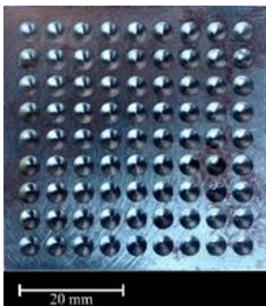
Rajah 2(a): Diameter 4 mm dan 81 lekukan
