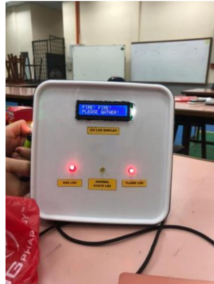
Rajah 7: Mengesan kehadiran api dan asap secara serentak
